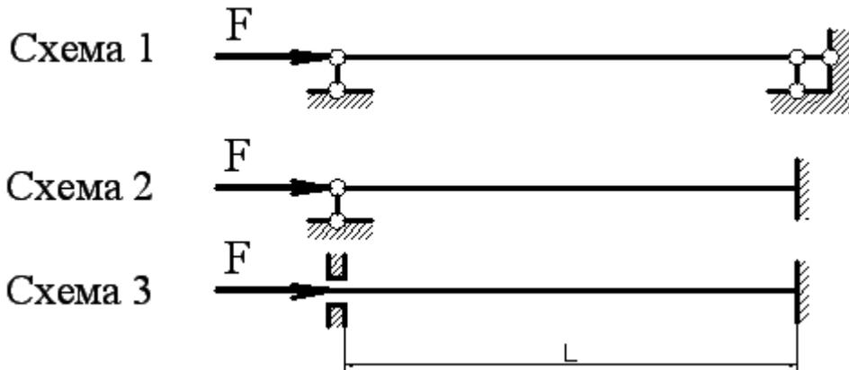
Расчетная схема неидеального стержня.
