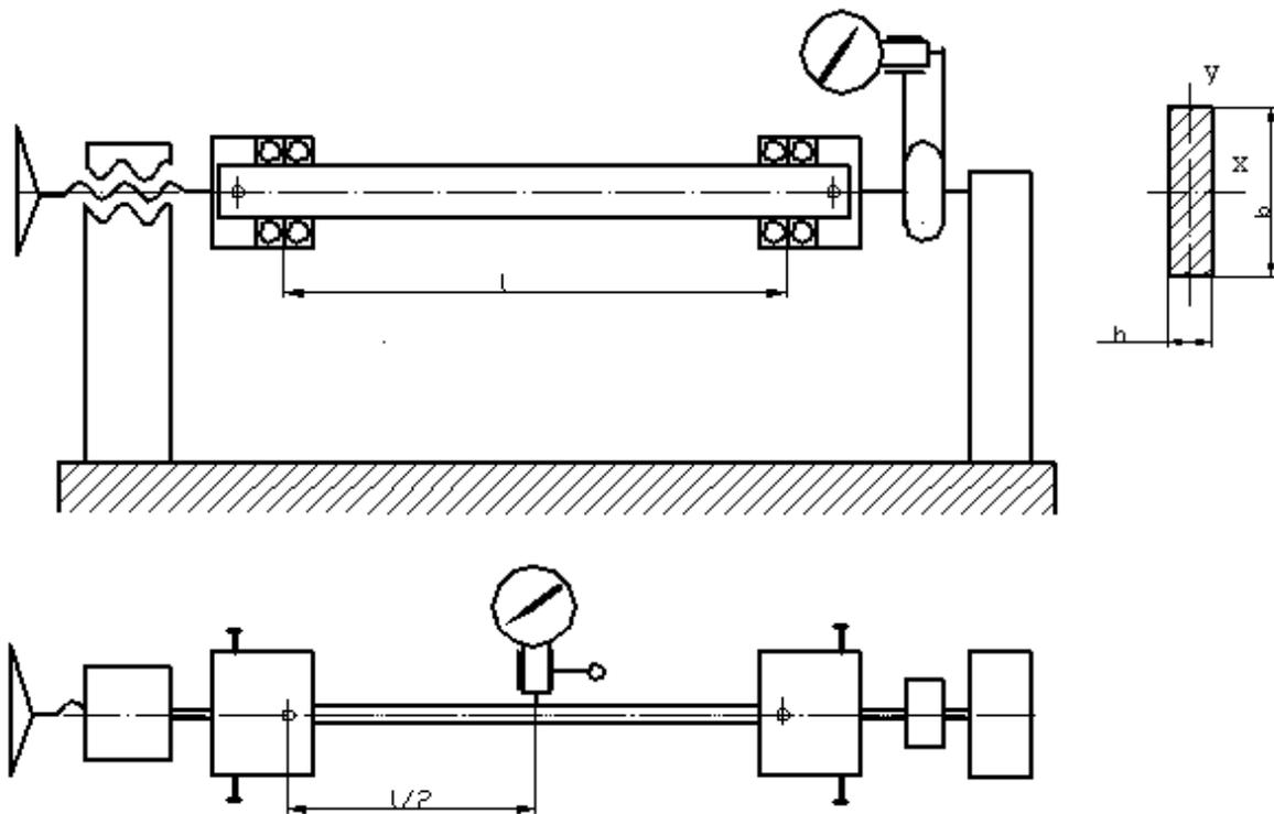
Правая опора соединена с динамометром, использующим тарированный индикатор часового типа, левая - с нагружающим устройством винтового типа. В среднем сечении стержня установлен прогибомер (индикатор часового типа на стойке).
