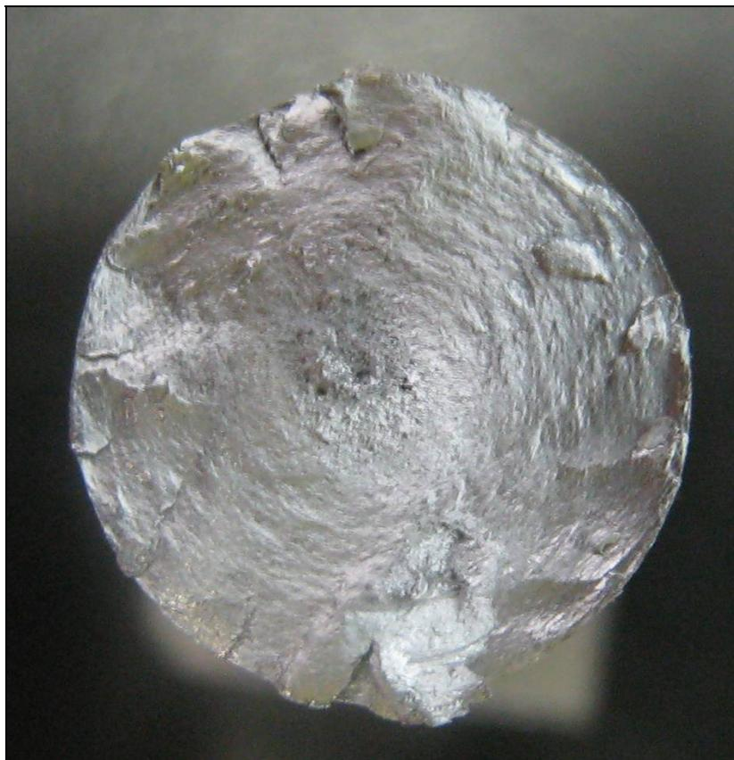
Фото 8.8. Поверхность стального образца в зоне разрушения.
