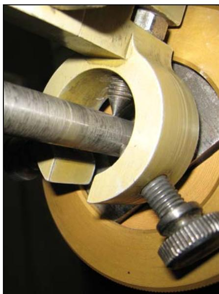
Фото 6.2 Закрепление угломера Бояршинова на образце.
